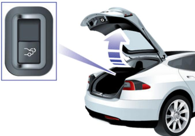
Si la Model S est équipée du hayon électrique, il n'est pas nécessaire de le soulever manuellement. Lorsque vous appuyez sur la commande de déverrouillage, le hayon s'ouvre, et lorsque vous tirez la commande vers le haut, il se ferme.
