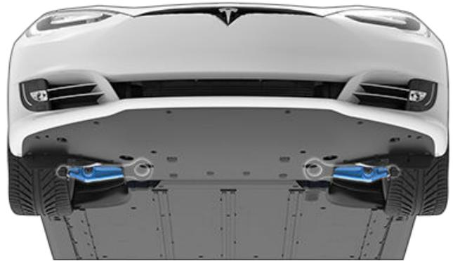
2. Pour protéger le soubassement de tout dommage, placez un élément (par exemple, un morceau de bois) entre les sangles et le soubassement.
