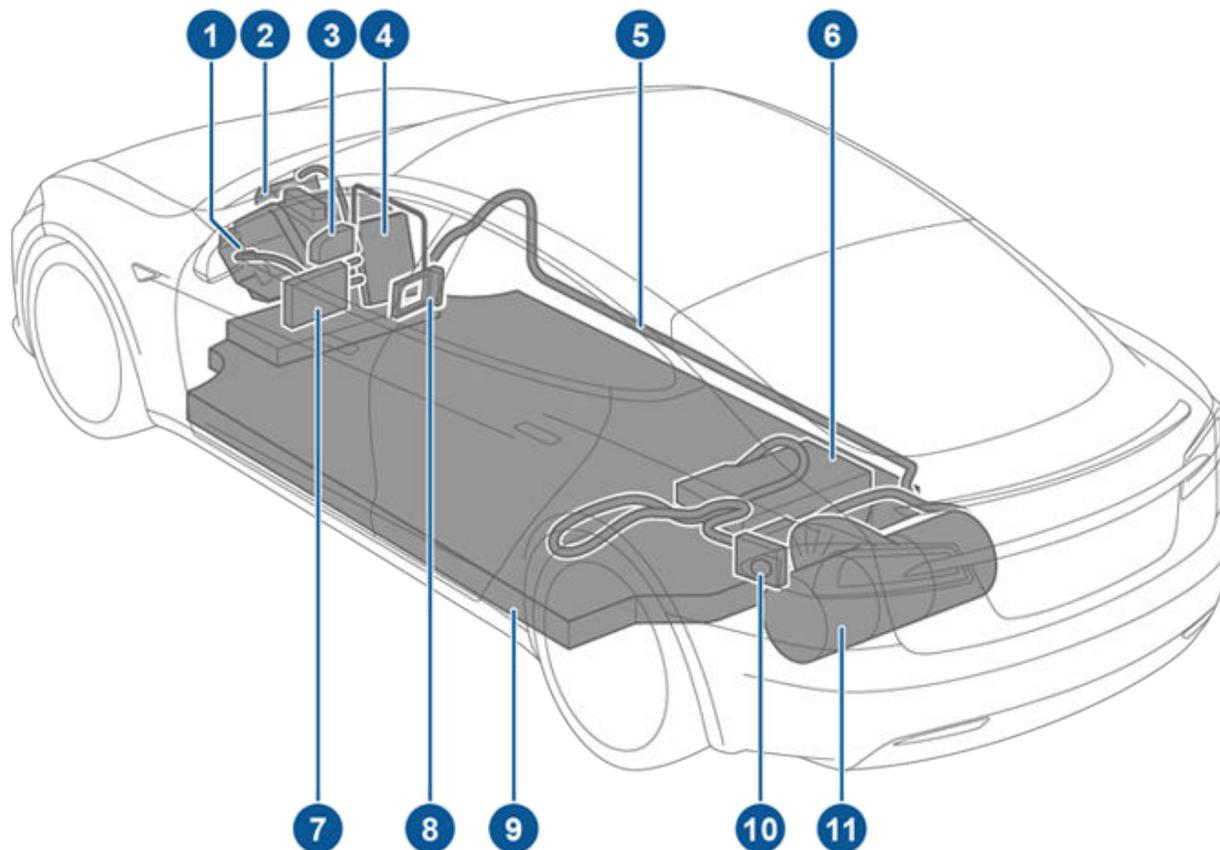
1. Moteur avant (véhicules à transmission intégrale uniquement)
