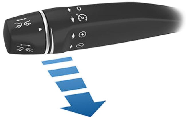
Pour reprendre le contrôle du véhicule à la vitesse actuelle, levez ou abaissez le levier d'Autopilot avant de le relâcher.
