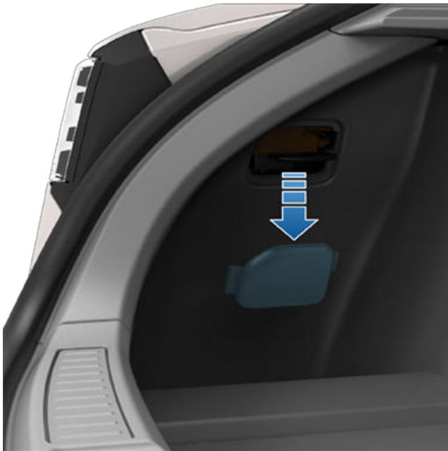
4. Poussez le levier de dégagement manuel de la prise de recharge (mis en surbrillance en rouge sur l'image) vers l'avant du véhicule et maintenez-le dans cette position pour déverrouiller le câble de recharge.
