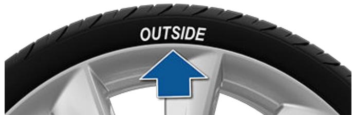
**AVERTISSEMENT :** La tenue de route se dégrade sérieusement si les pneus ne sont pas bien montés sur les roues.
