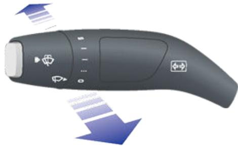
Les feux de route peuvent passer automatiquement en feux de croisement lorsqu'une source de lumière est détectée devant votre Model S (telle que les feux d'un véhicule). Pour activer ou désactiver cette fonctionnalité, appuyez sur **Contrôles > Feux de route automatiques** ou **Contrôles > Feux > Feux de route automatiques**.
