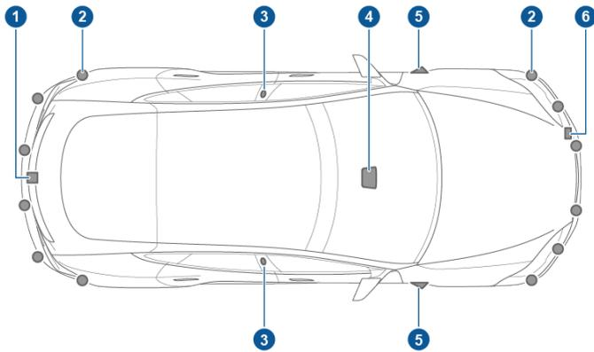
1. Une caméra est montée au-dessus de la plaque d'immatriculation arrière.
