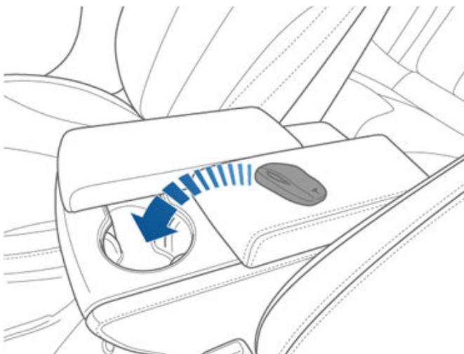
Si votre Model S ne parvient toujours pas à détecter la clé, essayez de la plaquer contre la console centrale, immédiatement en dessous de la prise de courant basse tension (voir [Basse tension Prise de courant à la page 10](#)). Sinon, essayez avec une autre clé. Si cela ne fonctionne pas avec l'autre clé, contactez Tesla.
