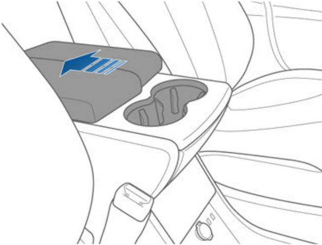
Pour dégager les porte-gobelets arrière (selon l'équipement), appuyez brièvement sur la façade des porte-gobelets, située au dos de la console centrale.
