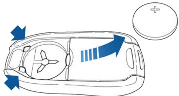
3. Insérez la pile neuve (type CR2032) avec le côté '+' orienté vers le haut.
