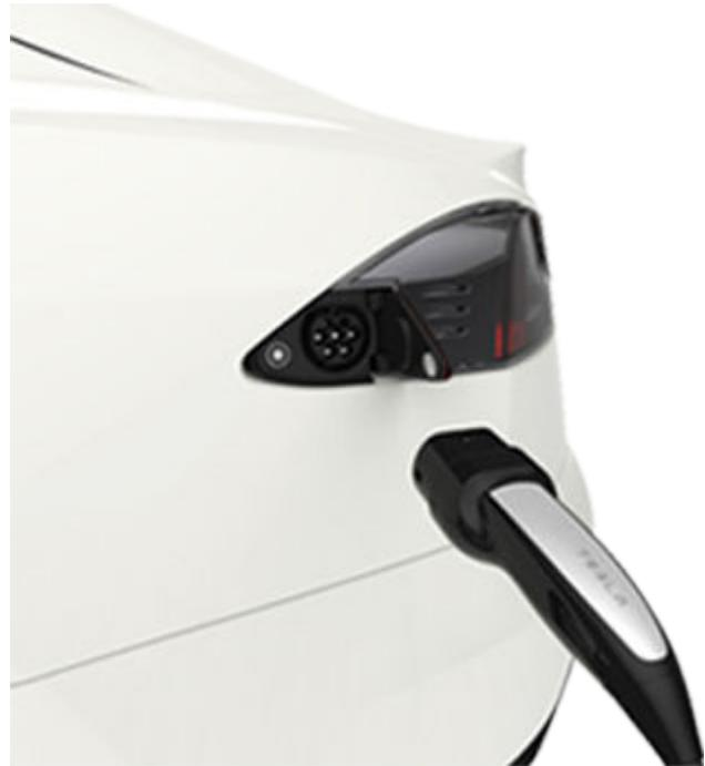
**REMARQUE :** Le témoin de la prise de recharge devient blanc lorsque vous ouvrez la trappe de la prise de recharge. Si vous n'insérez pas de câble de recharge dans la prise de recharge quelques minutes après avoir ouvert la trappe de la prise de recharge, la trappe de la prise de recharge se ferme. Dans ce cas, utilisez l'écran tactile pour ouvrir à nouveau la trappe de la prise de recharge.
