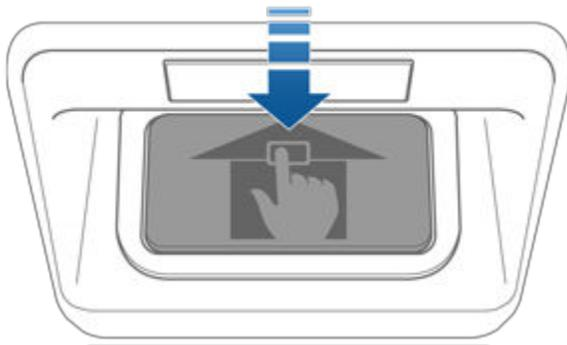
Appuyez sur le bouton de déverrouillage intérieur pour déverrouiller le coffre avant puis soulevez le capot.
