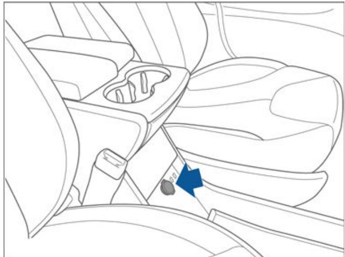
La fiche basse tension de la prise de courant est destinée aux accessoires nécessitant une alimentation maximale continue de 11 A (pic de 15 A) ou une puissance maximale continue de 150 W (pic de 180 W).
