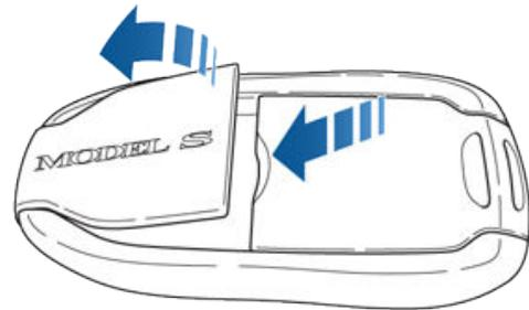
2. Retirez la pile en l'extrayant avec soin des clips de retenue avant.
