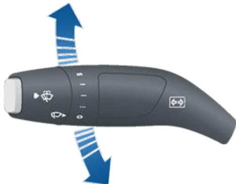
Les clignotants cessent de fonctionner lorsque votre volant de direction revient en position droite ou lorsque vous replacez le levier dans sa position centrale.
