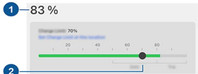
1. **Énergie disponible :** affiche l'énergie disponible restante de la batterie haute tension. Pour afficher l'énergie restante sous la forme d'une estimation de la distance de conduite restante (en miles ou en kilomètres) plutôt que sous forme de pourcentage, appuyez sur **Contrôles > Affichage > Affichage de l'énergie**.
