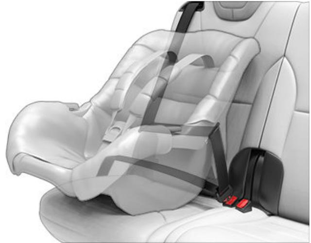
2. Laissez la ceinture de sécurité s'enrouler, et éliminez le jeu de la ceinture de sécurité tout en poussant fermement le siège de sécurité pour enfant dans le siège de votre Model S.
