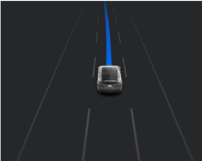
Lorsque la Navigation en Autopilot est activée et que vous approchez d'une sortie ou d'un échangeur sur votre itinéraire, le clignotant approprié s'active et l'Assistance au maintien de cap manœuvre votre Model S de manière à emprunter la sortie ou l'échangeur.
