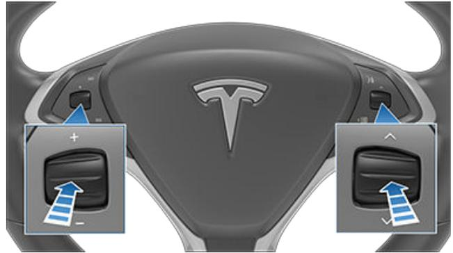
3. Au bout de quelques secondes, le logo Tesla apparaît. Attendez environ 30 secondes que l'écran tactile redémarre. Si l'écran tactile ne répond toujours pas ou si son comportement reste inhabituel au bout de quelques minutes, essayez de mettre le véhicule hors tension, puis de nouveau sous tension (si possible). Voir [Mise hors tension, puis sous tension du véhicule à la page 63](#).
