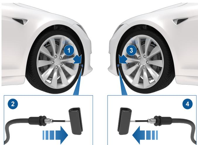
**REMARQUE :** Il est important de tirer sur les sangles dans le bon ordre, sinon le bon loquet ne se désengage pas et il est impossible d'ouvrir le coffre avant.
