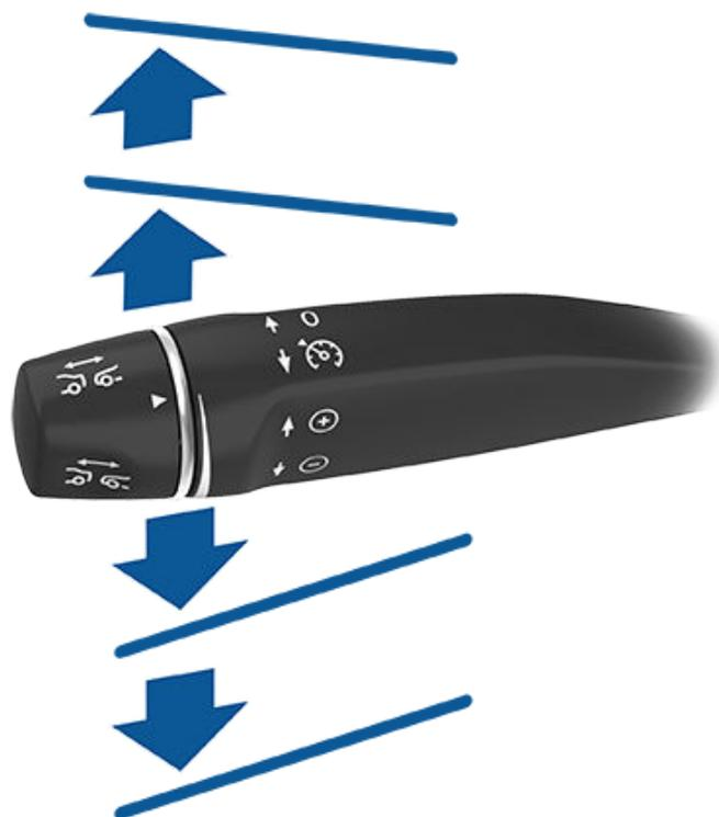
Pour augmenter/réduire la vitesse de 1 km/h, déplacez le levier vers le haut ou vers le bas en première position et relâchez-le. Pour augmenter/réduire la vitesse jusqu'à l'incrément de 5 km/h le plus proche, déplacez le levier vers le haut ou vers le bas en deuxième position et relâchez-le. Par exemple, si vous conduisez à 83 km/h et que vous
