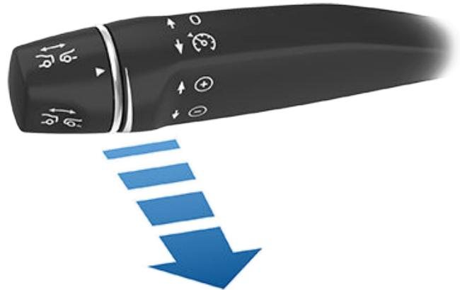
**REMARQUE :** Si le paramètre pour **Activation de l'Autopilot** est défini sur **Tirer une fois** (appuyez sur **Contrôles > Autopilot > Activation de l'Autopilot**), l'Assistance au maintien de cap est engagée lorsque vous tirez le levier d'Autopilot une fois vers vous. Si le paramètre est défini sur **Tirer deux fois**, vous devez tirer le levier d'Autopilot rapidement deux fois de suite vers vous pour enclencher l'Assistance au maintien de cap.
